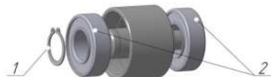
Рисунок 6. Ролик натяжной УМДУ-80/82.02.09
